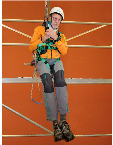
Abb. 3 Halteseil mit Längeneinstellvorrichtung
